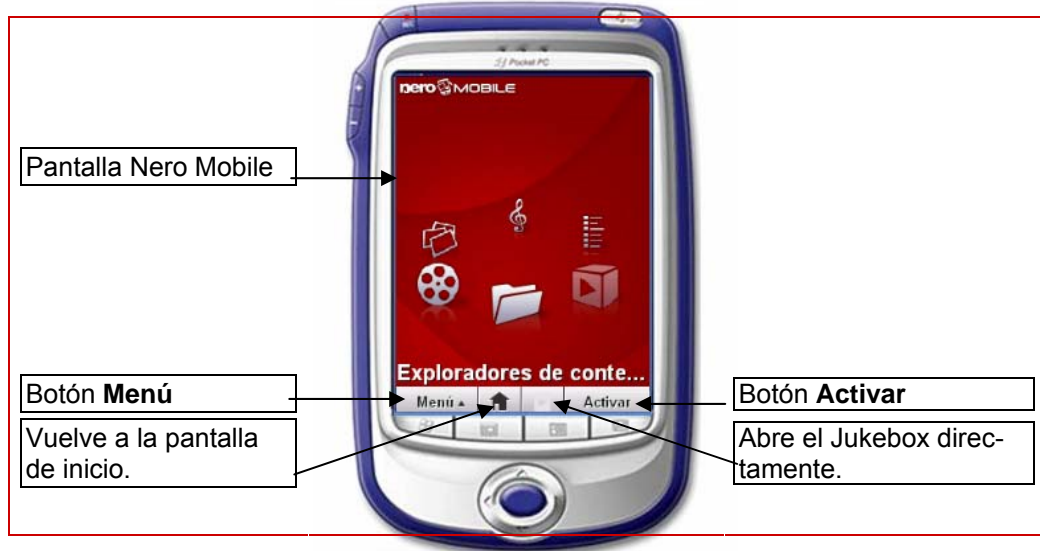
Fig. 2: Elementos de control para PDA
